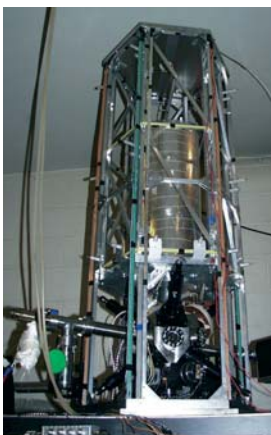
HORLOGE À ATOMES FROIDS Elle utilise comme référence des atomes de césium et de rubidium.
