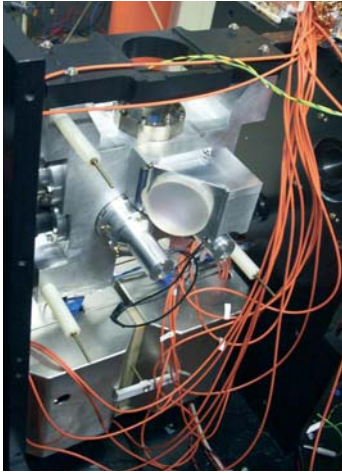
GYROMÈTRE À ATOMES FROIDS L'expérience mesure des rotations et des changements d'orientation.
