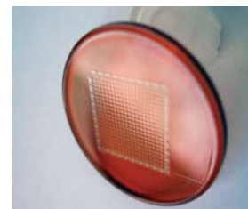
MATRICE DE 20x20 MICROLENTILLES Ce composant optique, conçu à l'Observatoire de Paris, permet l'analyse de la distorsion des images par la turbulence de l'atmosphère.
